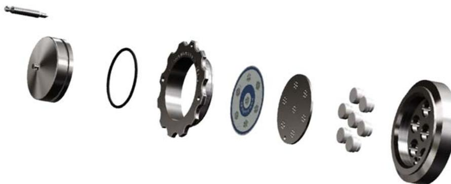
Микропорт Multi Micro Port 49 имеет 7 мембран, помещенных в корпус и удерживаемых внутренней стальной пластиной, которая, в свою очередь, фиксируется кольцевой гайкой. Во внутренней стальной пластине предусмотрены 7 небольших отверстий спереди каждой
